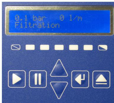
Abbildung 21: Displayanzeige (hier im Filtrationsmodus)
